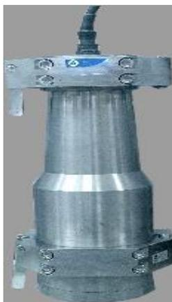
Внешний вид блока детектирования из состава УДГБ-47Р, масса 84 кг, диаметр – 228, высота – 505 мм.
